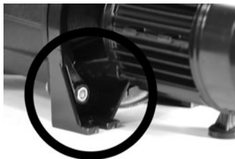
Regelmäßige Kontrolle auf Dichtheit! (Bei undichter Gleitringdichtung schwere Folgeschäden!)
